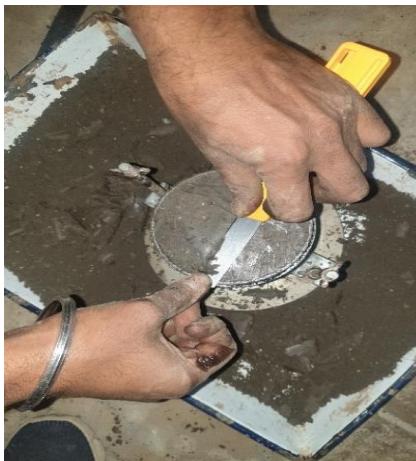
(d) Smoothing top surface before final weight
