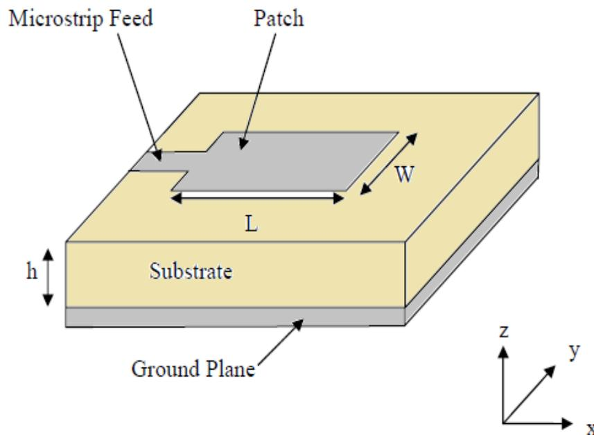
Fig. 2.9. A microstrip antenna.
