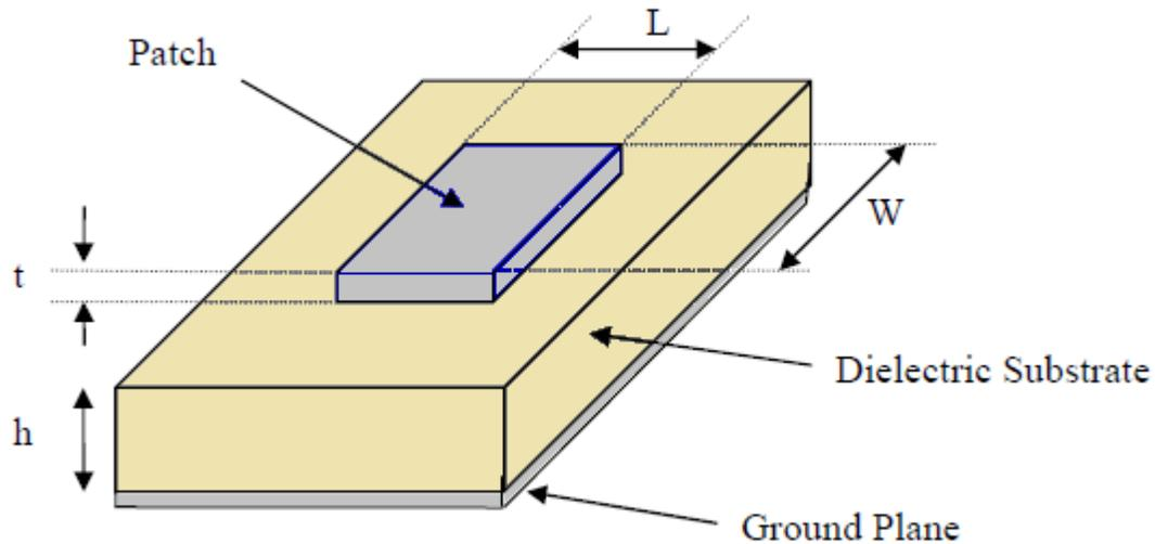
Fig.2.1. A Microstrip Antenna.
