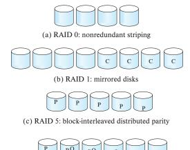
(d) RAID 6: P + Q redundancy
