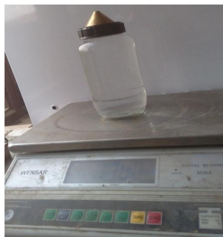
Fig. 3.3.2 (d) M_4 Mass of pycnometer with water
