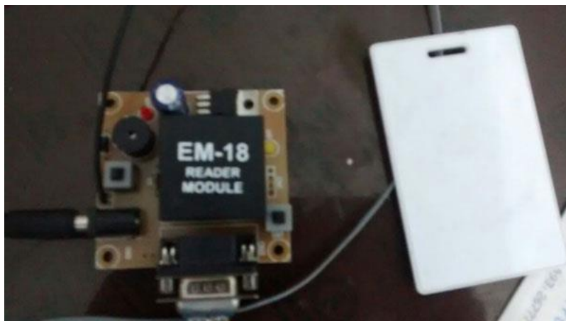
Fig. 5.2 EM-18 RFID MODULE
