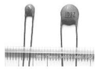
Fig 20. CERAMIC CAPACITORS
