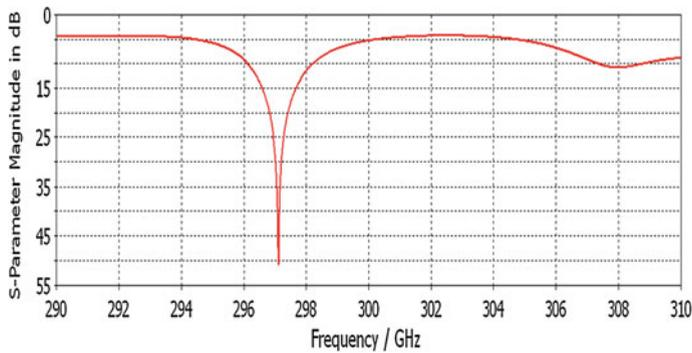
**Fig. 12**  $S_{11}$  parameter of scaled down antenna
