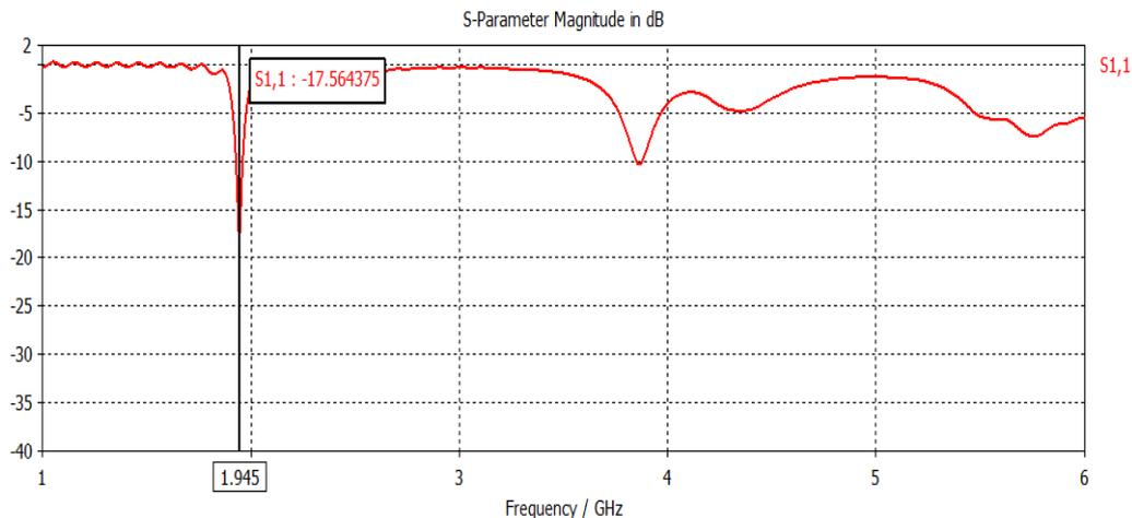
Figure 2: S11 parameter for antenna 1
