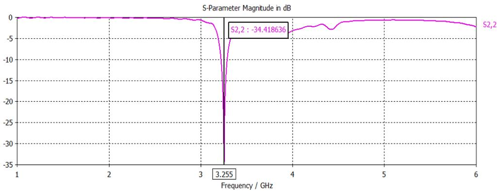
Figure 3: S22 parameter for antenna 2
