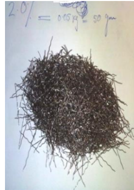
(d) 2.0% steel fibers of total volume fraction of concrete
